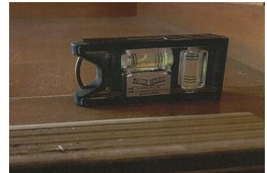
建物の傾き状況を水平器で測定
