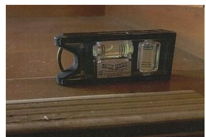
建物の傾き状況を水平器で測定
